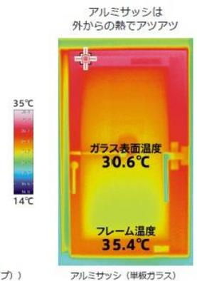
【サーモグラフィ撮影条件】 室外温度：32.6°C、室内温度：25.3°C
