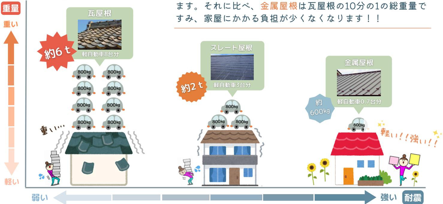
瓦屋根は一坪約200kgの重量があります。30坪の住宅の総重量で計算すると約6tもの重量が家屋に負担をかけています。それに比べ、**金属屋根**は瓦屋根の10分の1の総重量ですみ、家屋にかかる負担が少なくなります！！
